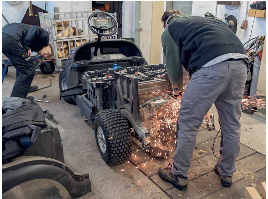
Unser Caddy bekommt eine stabilere Anhängerkupplung.
